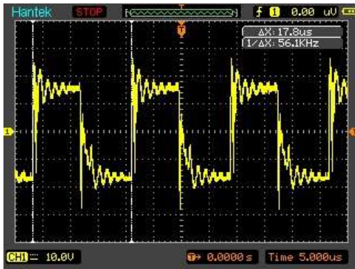
Fig.6. Forma de onda en el primario del transformador.
